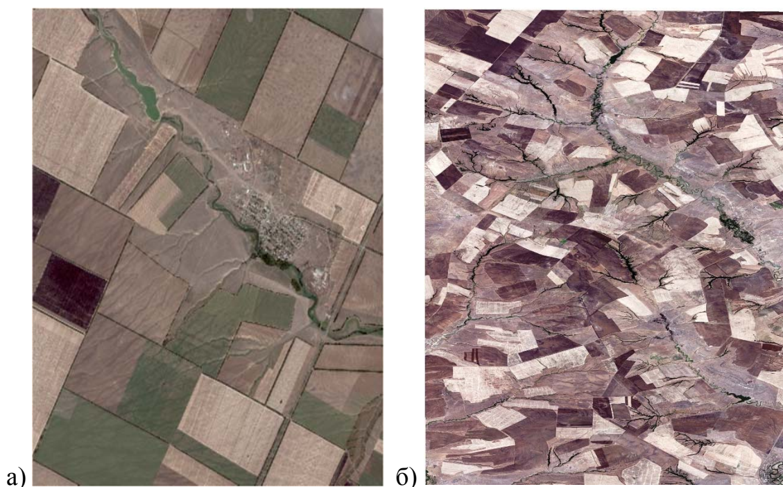
Рис. 4. Космические изображения развития эрозионных процессов на пахотных землях бассейна р. Цимлы (ИСЗ “WorldView-2” 2011): а) струйчатая, ручейковая, б) ложбинно-овражная эрозия
